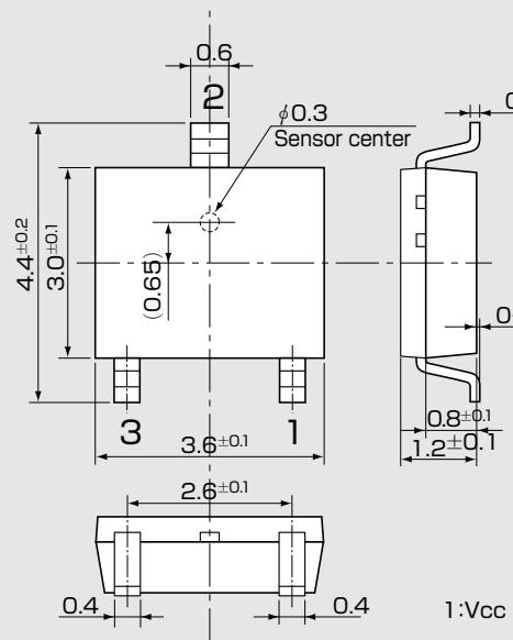
※注 センサの中心は $\phi 0.3\text{mm}$ の円内に位置します。
